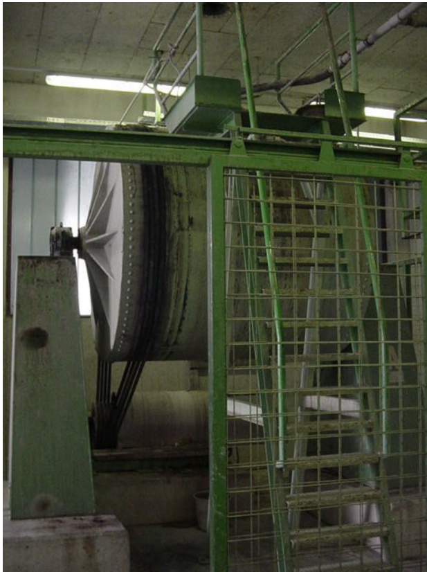
Mletje surovin v proizvodnem mlinu kapacitete 5000 kg (ETI Elektroelement)
