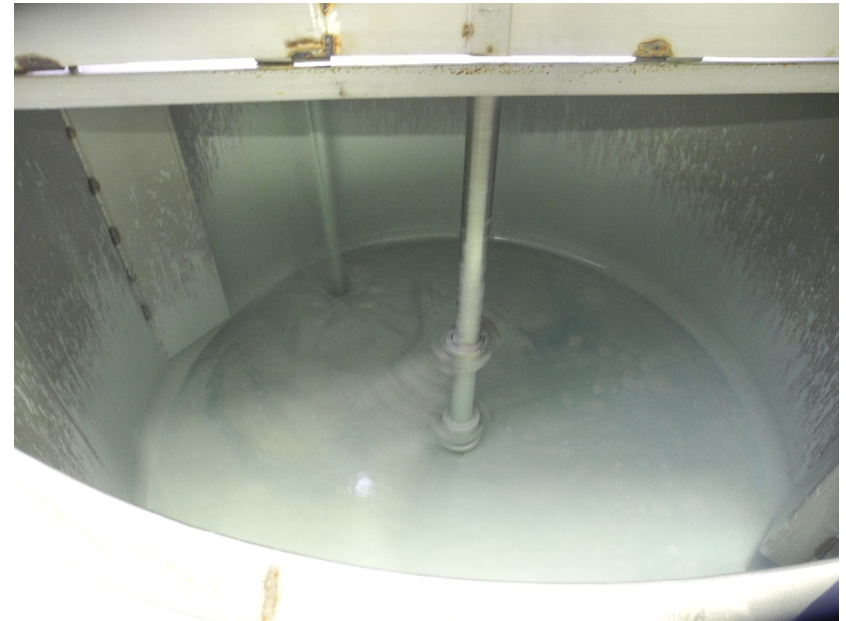
Mletje surovin v proizvodnem mlinu kapacitete 5000 kg (ETI Elektroelement)
