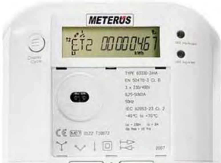
Smart Meter: intelligenter Stromzähler (EVB Energie AG / wikipedia-co-by-sa)
